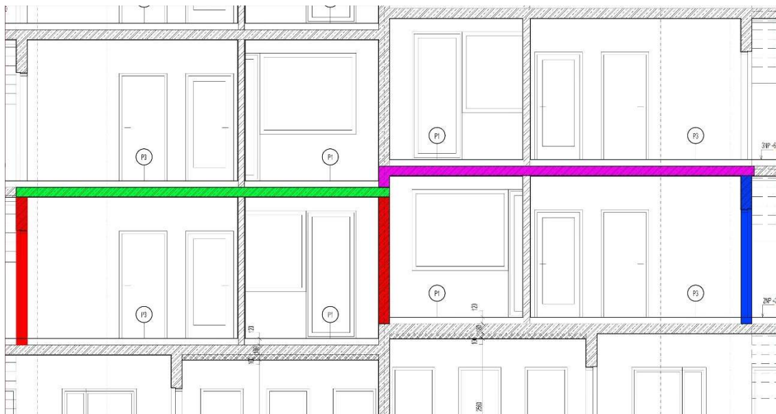
Obrázek 1: Schéma postupu výstavby hrubých konstrukcí po patrech
