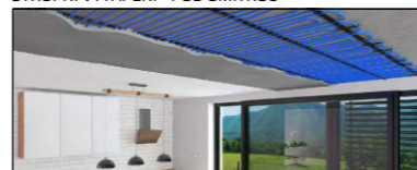
STROPNÍ VYTÁPĚNÍ - V SÁDROKARTONOVÉM PODHLEDU
