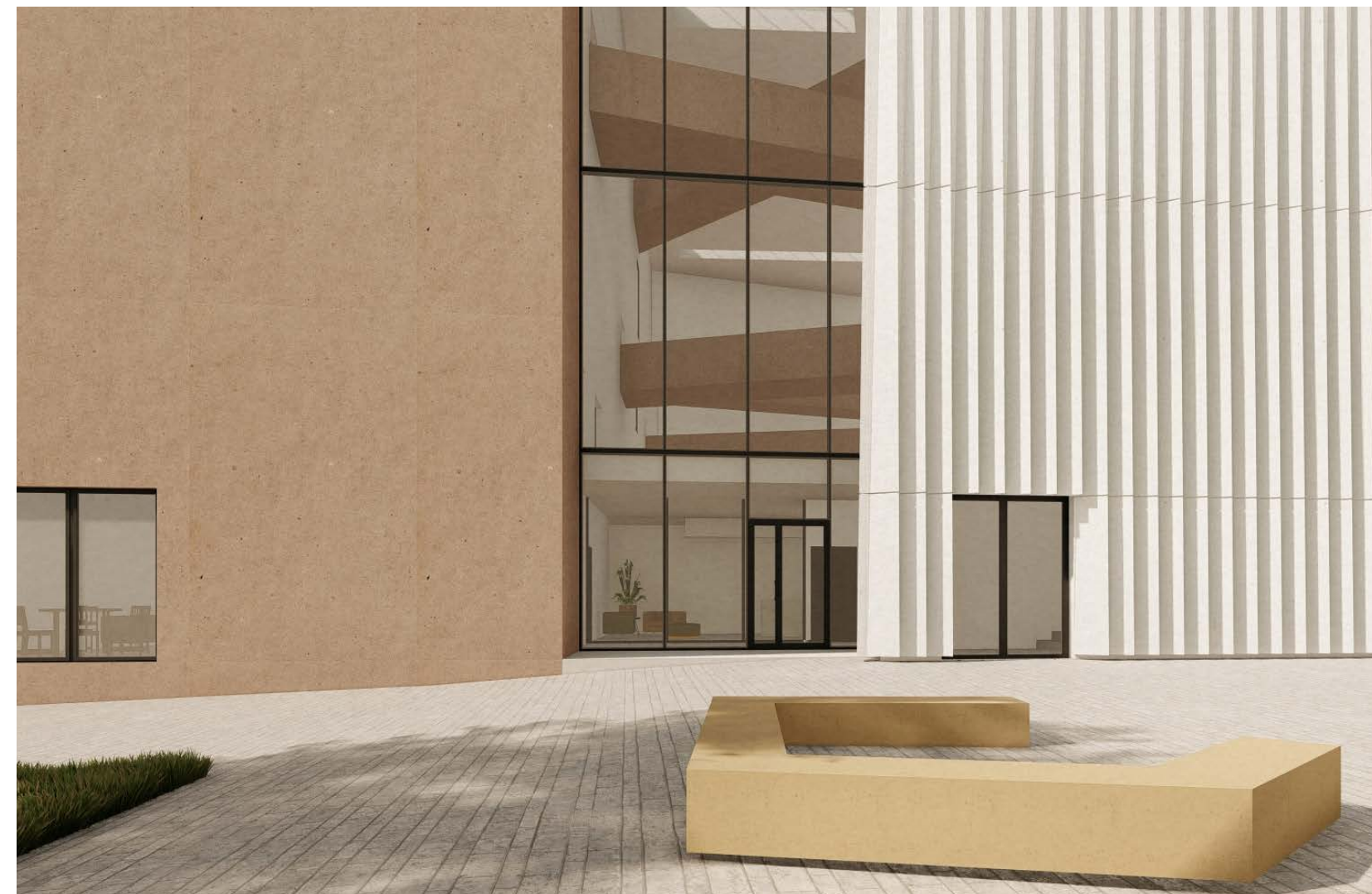
Vstupní část pro zaměstnance a průhled na masivní můstky ve foyer. Jednotlivé pily fasády se směrem vzhůru zmenšují a dodávají tak fasádě dynamiku. V místě otvorů jsou pily v kratším směru přerušeny a tím se dostává do interiéru rozptýlené světlo.
