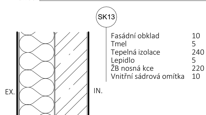
Obvodová stěna - restaurace + divadlo U = 0,12 \text{ W/m}^2\text{K}
