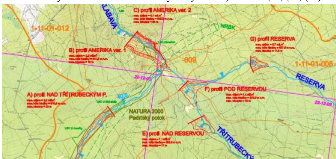
Obrázek 17 – Navržené profily suchých retenčních nádrží dle Studie odtokových poměrů v povodí Klabavy (2007) Zdroj: https://knihovna.nature.cz/files/28580
