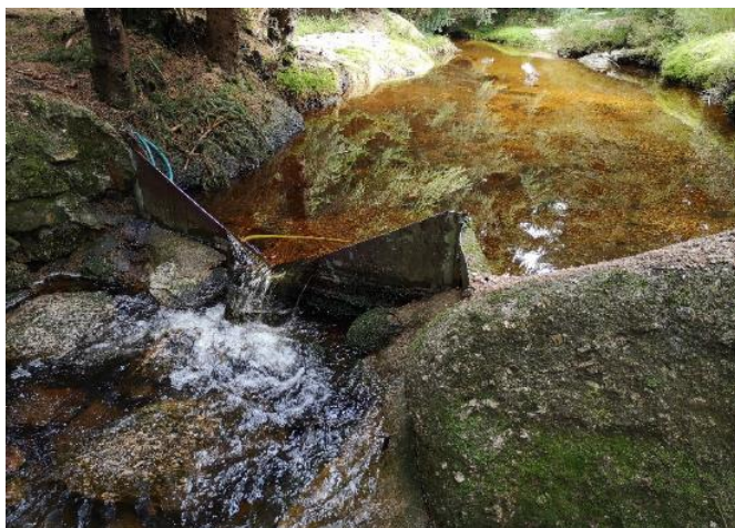
Obr. 6.2.1 - Měrný přeliv Porsche, vzorkovač vody z Černé Nisy (vpravo)
