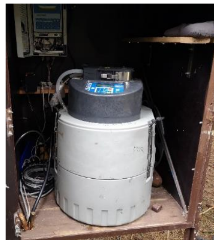
Obr. 6.2.1 - Měrný přeliv Porsche, vzorkovač vody z Černé Nisy (vpravo)
