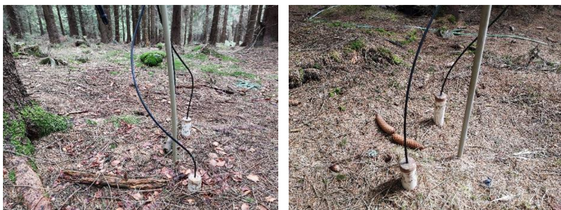
Obr. 6.2.5 - Vlevo lyzimetry PV8 v horní části svahu, vpravo lyzimetry PV1
