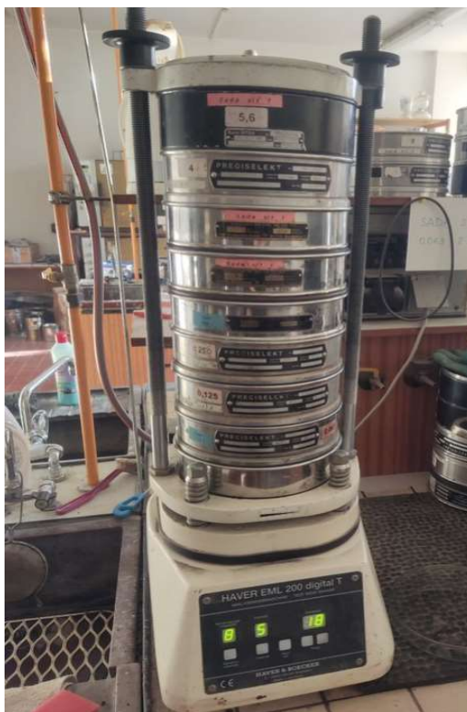
Obr. 8 - Sada zkušebních sít během prosévání
