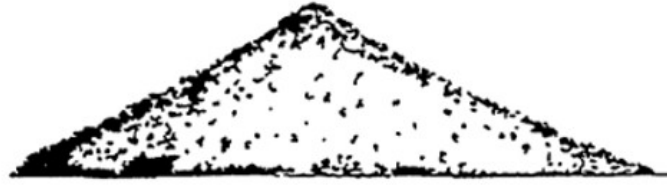
Obr. 11 - Předepsaný rozpad povrchově osušeného kameniva
