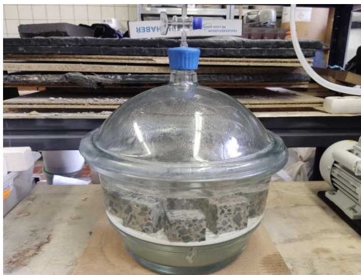
Obr. 14 - Exsikátor se zkoušenými vzorky
