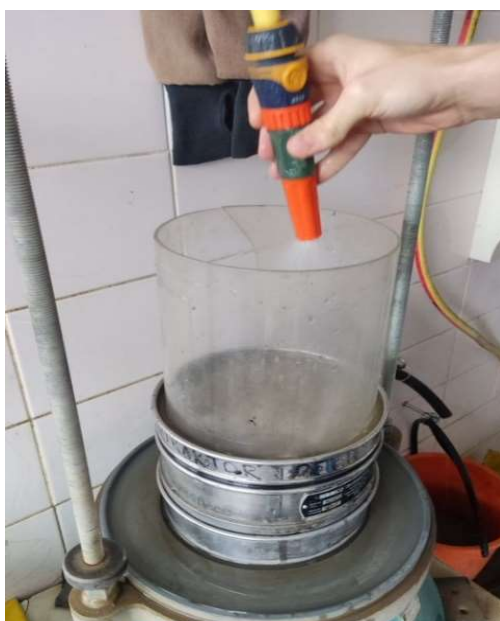
Obr. 9 - Průběh praní zkušební navážky
