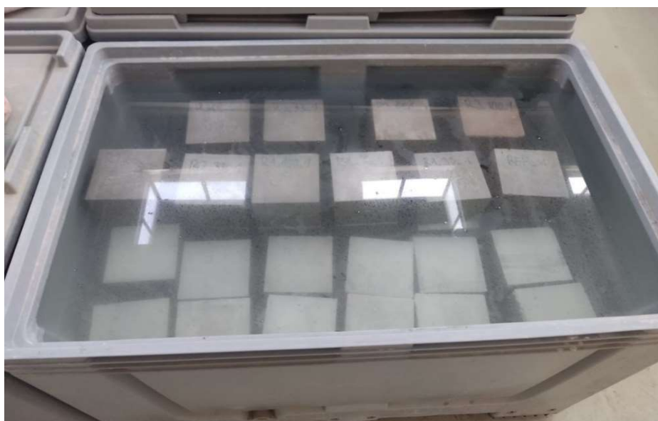
Obr. 23 - Uskladnění betonových zkušebních těles
