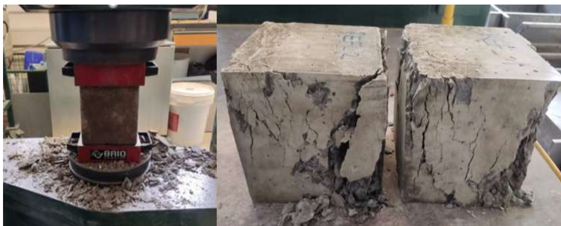
Obr. 15 - Zkušební lis a porušená zkušební tělesa
