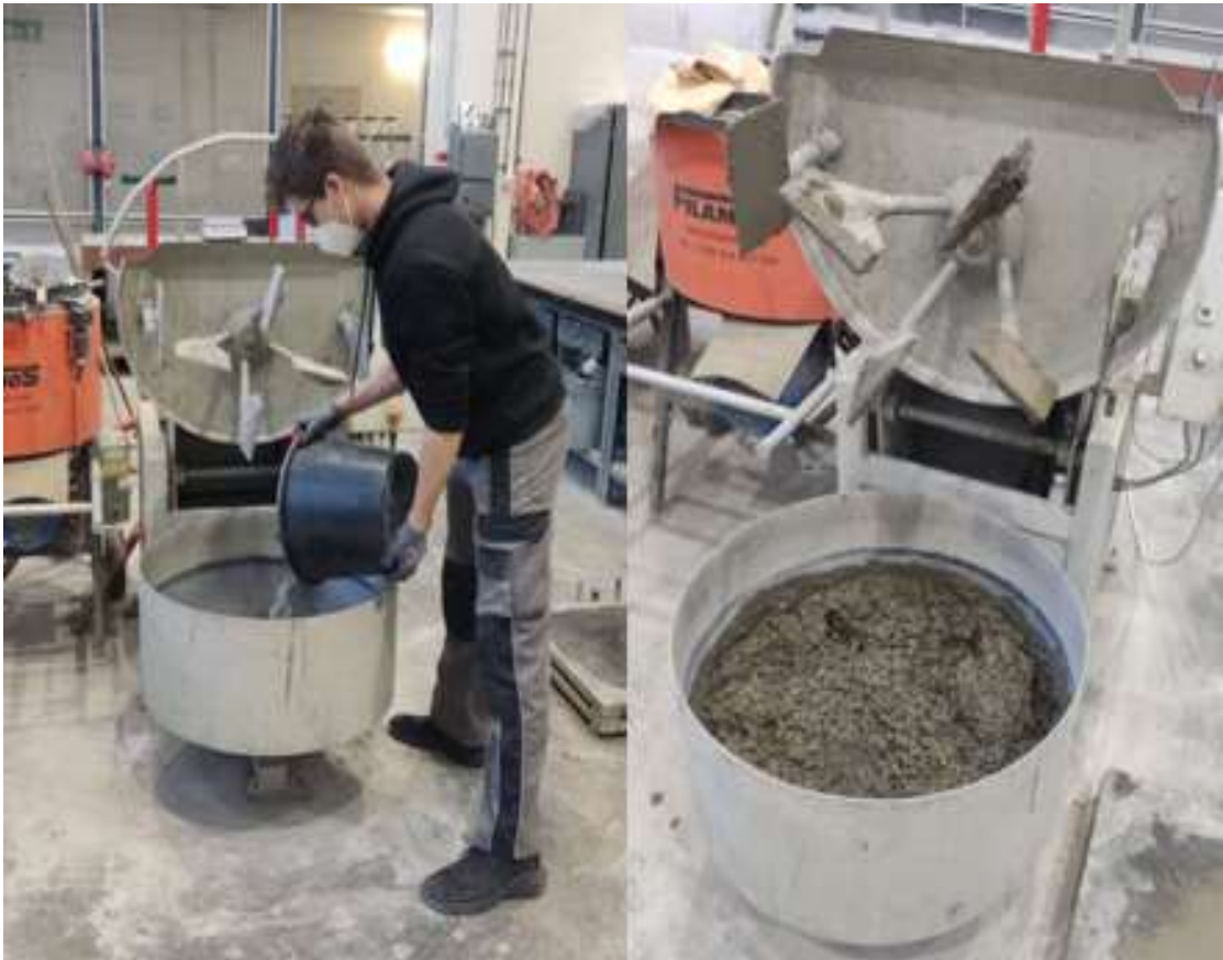
Obr. 20 - Výroba betonu v míchačce
