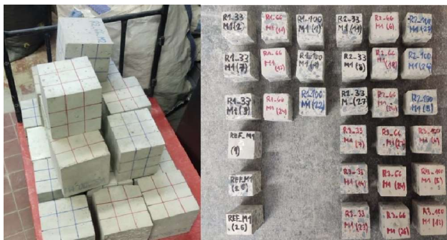
Obr. 13 - Zkušební vzorky pro provedení zkoušky nasákavosti
