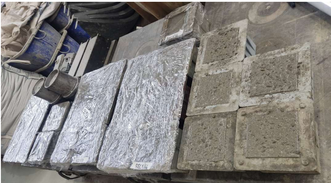
Obr. 21 - Plastové formy s betonem během tuhnutí
