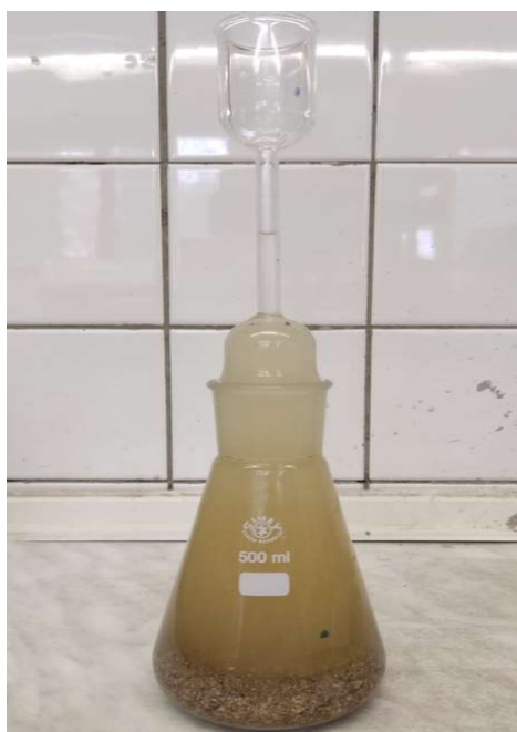
Obr. 10 - Pyknometr s kamenivem a vodou
