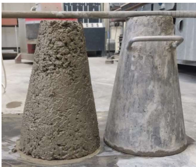
Obr. 12 - Měření poklesu betonu
