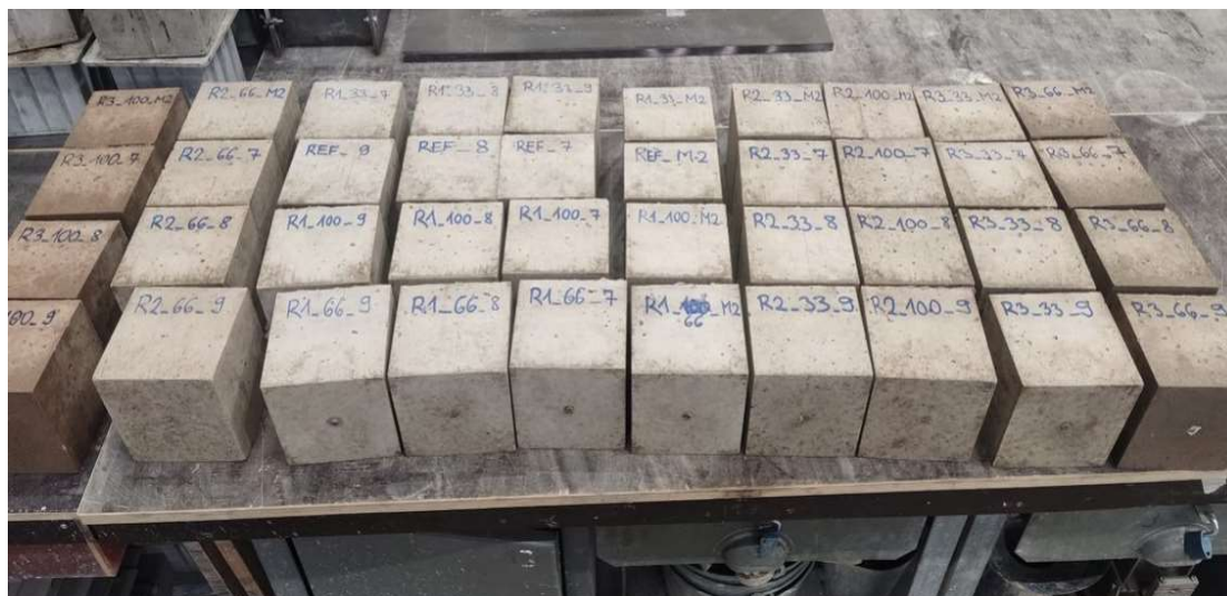
Obr. 22 - Zkušební krychlová tělesa krátce po odbednění
