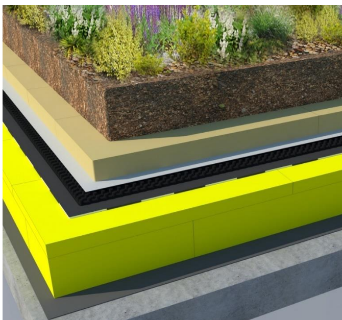
Obrázek 21 Souvrství se substrátovou deskou Isover Flora, zdroj: e-isover.cz
