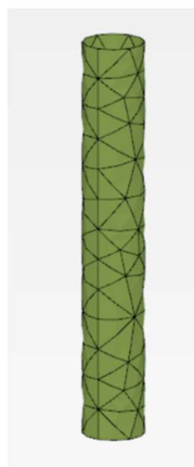
Obr. 88 Plášť piloty, výstup z programu PLAXIS 3D
