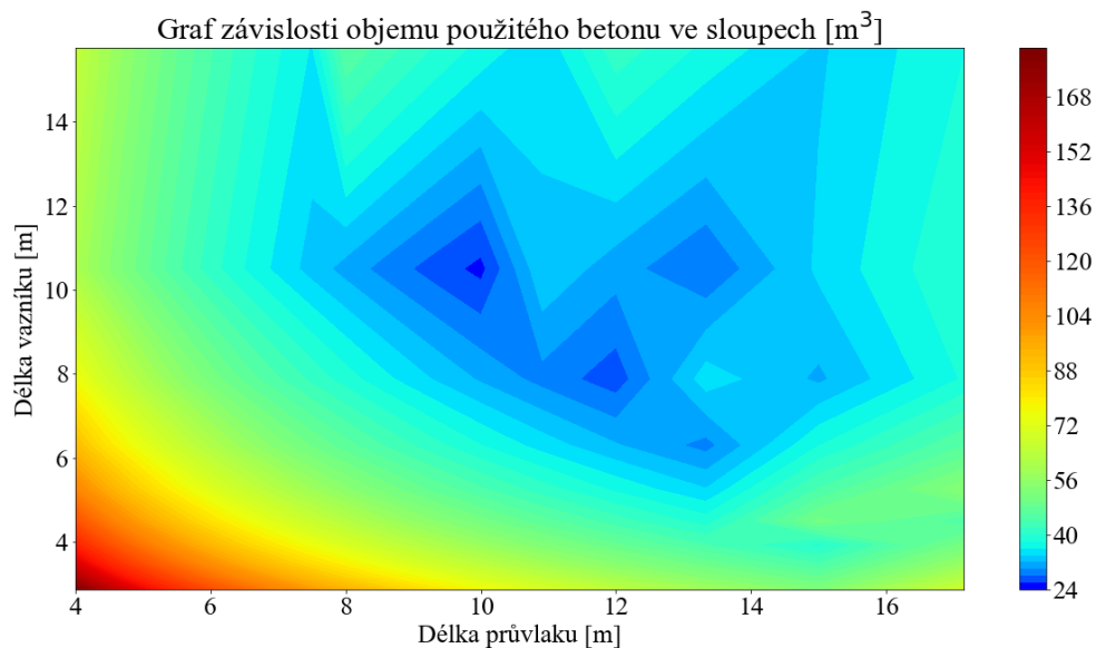
Obr. 2.8: Maximální hodnoty objemu použitého betonu ve všech sloupech
