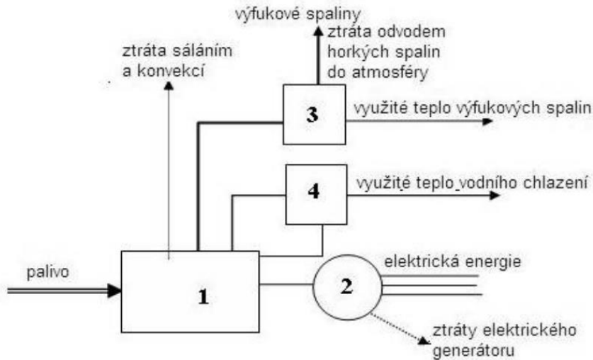
1 spalovací motor; 2 elektrický generátor; 3 výměník tepla spaliny/topná voda; 4 výměník tepla chladicí voda/topná voda
