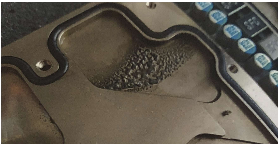
Obrázek 3: Sedimenty a nečistoty ve vodním výměníku na grafické kartě (4)
