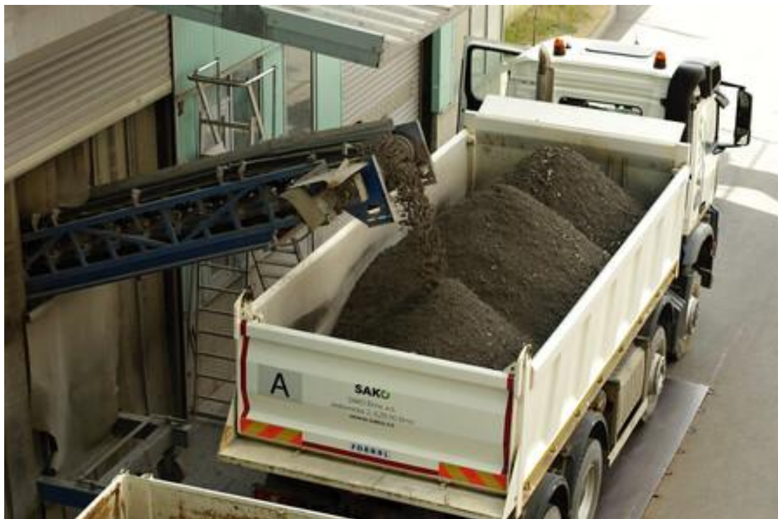
Obrázok 13: Škvára po spálení odpadu (zdroj: www.ekolist.cz )
