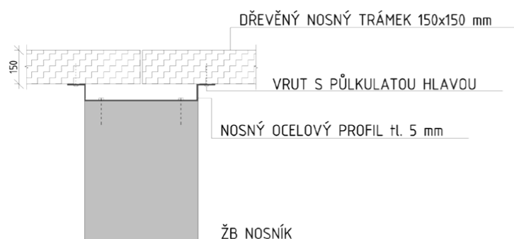
DETAIL NAPOJENÍ NOSNÝCH TRÁMKŮ NA ŽB NOSNÍK
