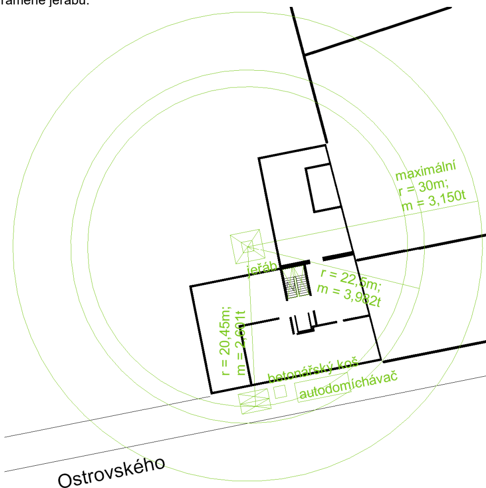
Schéma dosahu ramene jeřábu:
