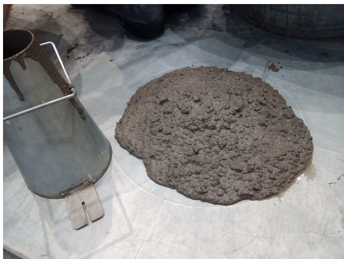
Obrázek 13: Stupeň konzistence S5 čtvrté sady
