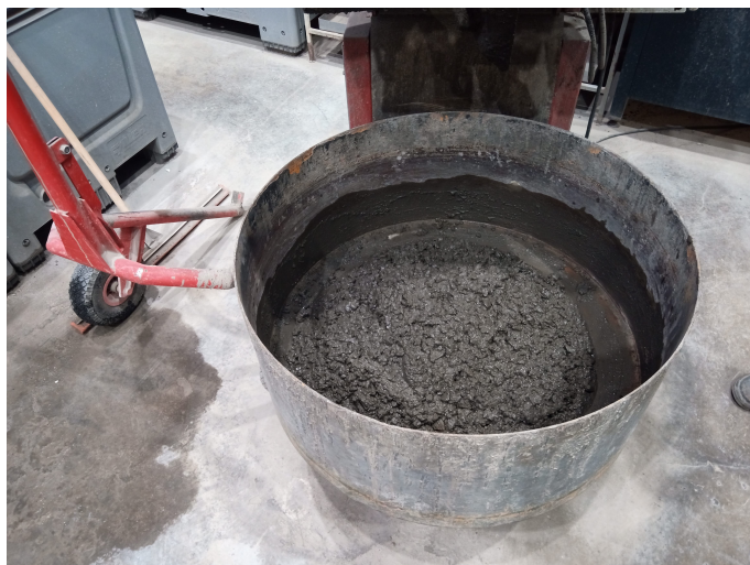
Obrázek 12: Betonová směs na první sadu krychlí
