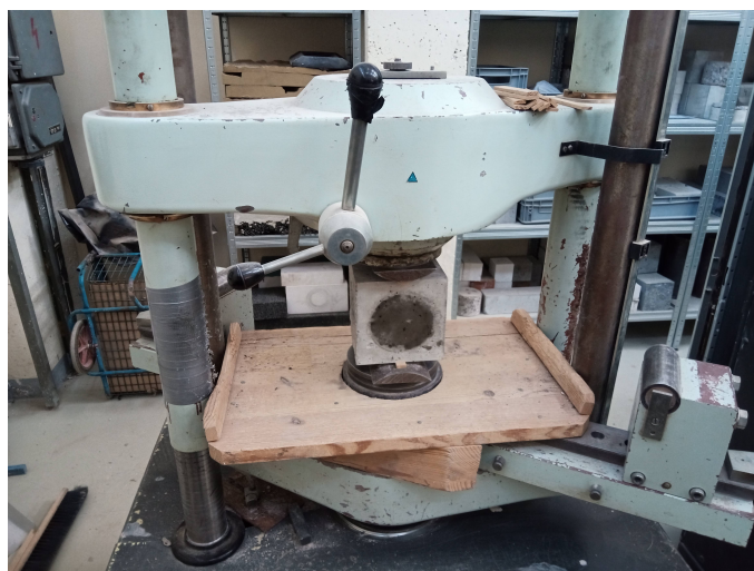
Obrázek 20: Rozlomení vzorků, první sada
