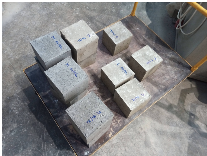
Obrázek 15: Odbedněné vzorky první a druhé sady
