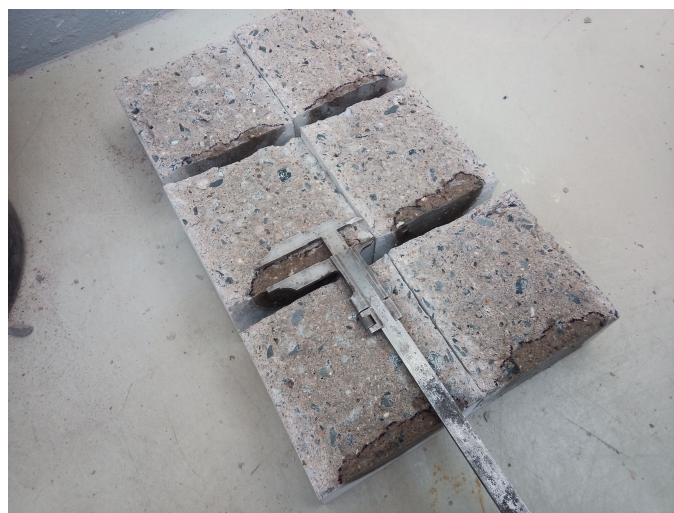
Obrázek 21: Odečítání hloubky průsaku páté sady
