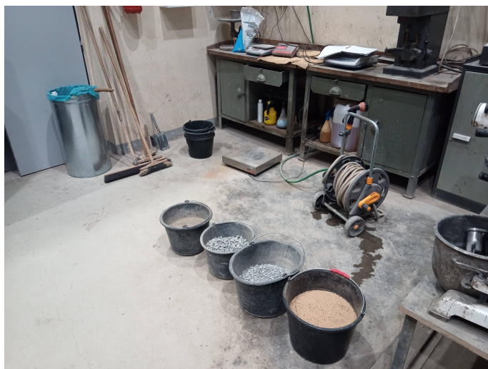
Obrázek 8: Kamenivo a cement navážené pro výrobu druhé sady
