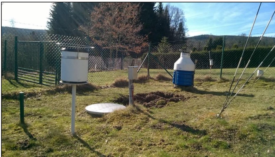
Obrázek 5: Vlevo překlopný srážkoměr, vpravo váhový srážkoměr
