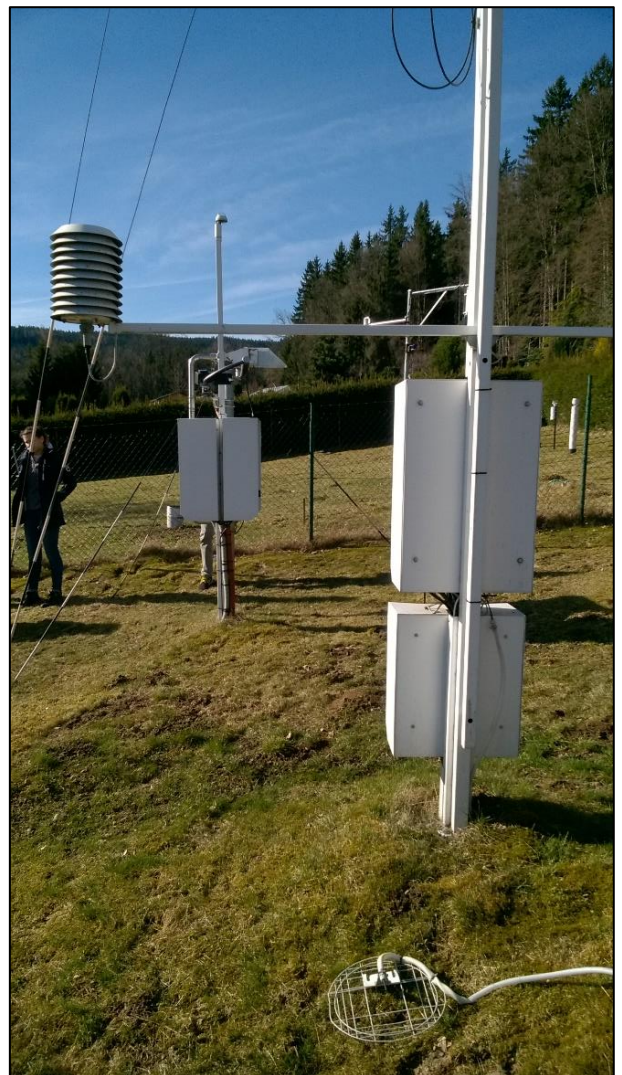
Obrázek 34: Měření relativní vlhkosti na meteostanici Na Lizu
