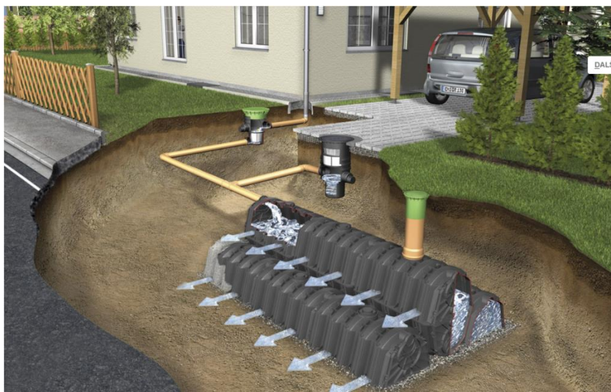
Obrázek č.12 – Akumulační nádrž [9]
