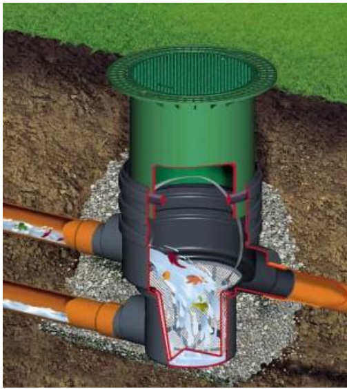
Obrázek č. 7 a 8 – Průřez košičkovými filtry [13]
