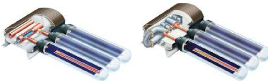
Obrázek 25 Trubkové jednotěnné vakuové kolektory: s přímo protékáním koncentrickým potrubím (vlevo), s tepelnou trubicí (vpravo), zdroj: Viessmann
