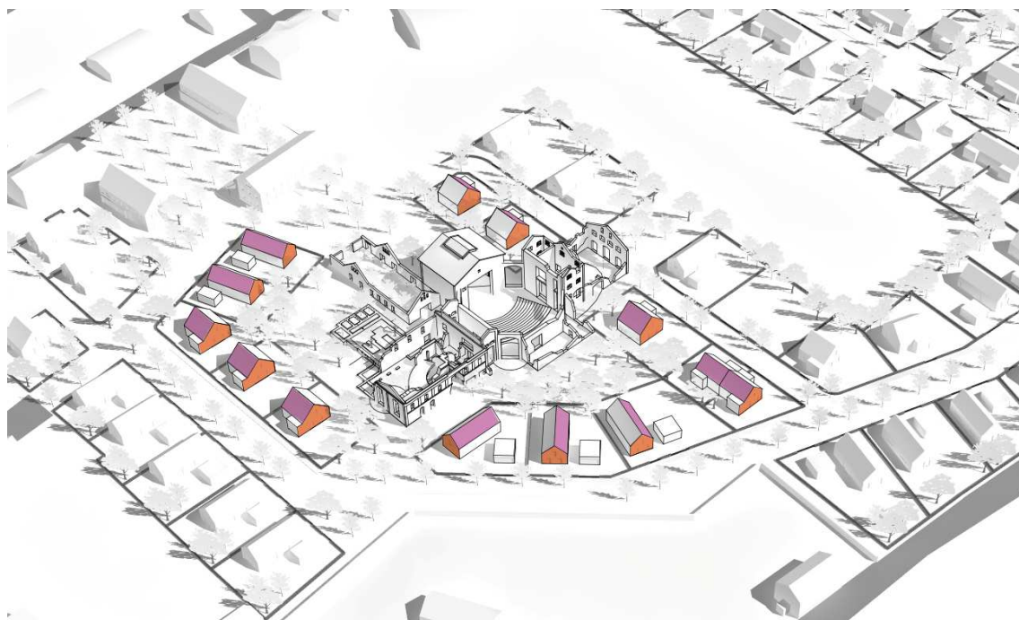
Obrázek 78 Cukrovar Lenešice - vymezení vhodných ploch pro FV (fialově) a FT (červeně) systémy autor: Štěpán Lajda, Podklad: MS architekti
