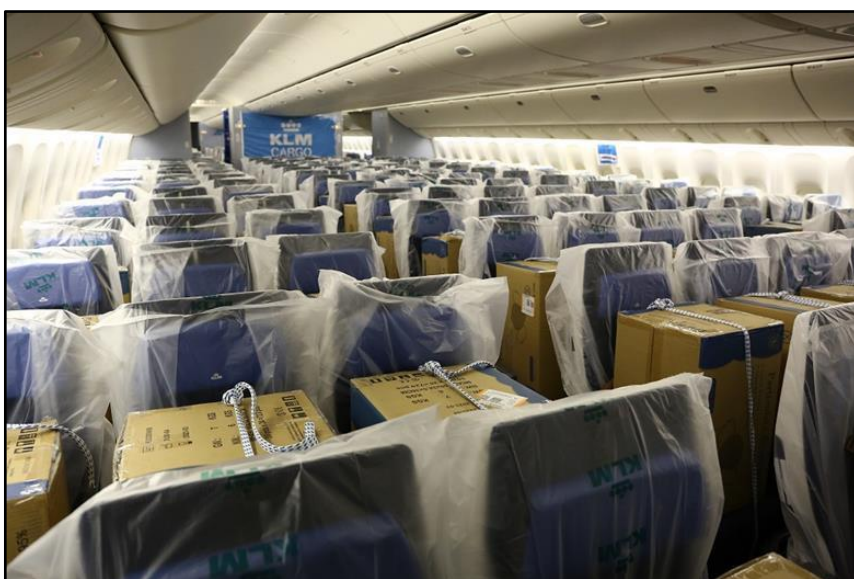
Obrázek 6: Přeprava zboží na palubě Boeingu 777 v konfiguraci preighteru bez provedení demontáže sedadel; zdroj: (84)
