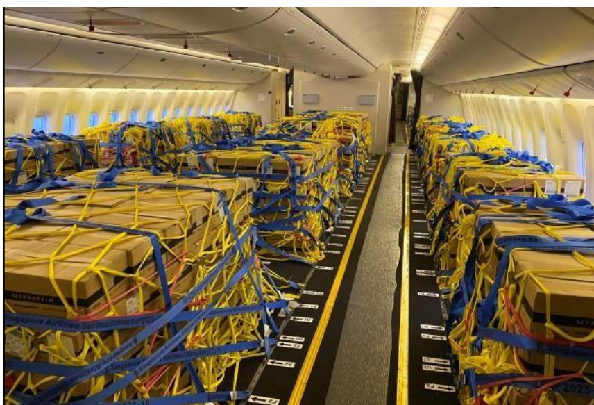
Obrázek 6: Přeprava zboží na palubě Boeingu 777 v konfiguraci preighteru s provedenou demontáží sedadel; zdroj: (84)
