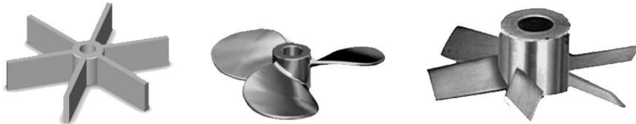
Obrázek 2: Typy míchadel: zleva 1) lopatkové s kolmými lopatkami, 2) vrtulové, 3) lopatkové se šikmo skloněnými lopatkami, zdroj: [6]
