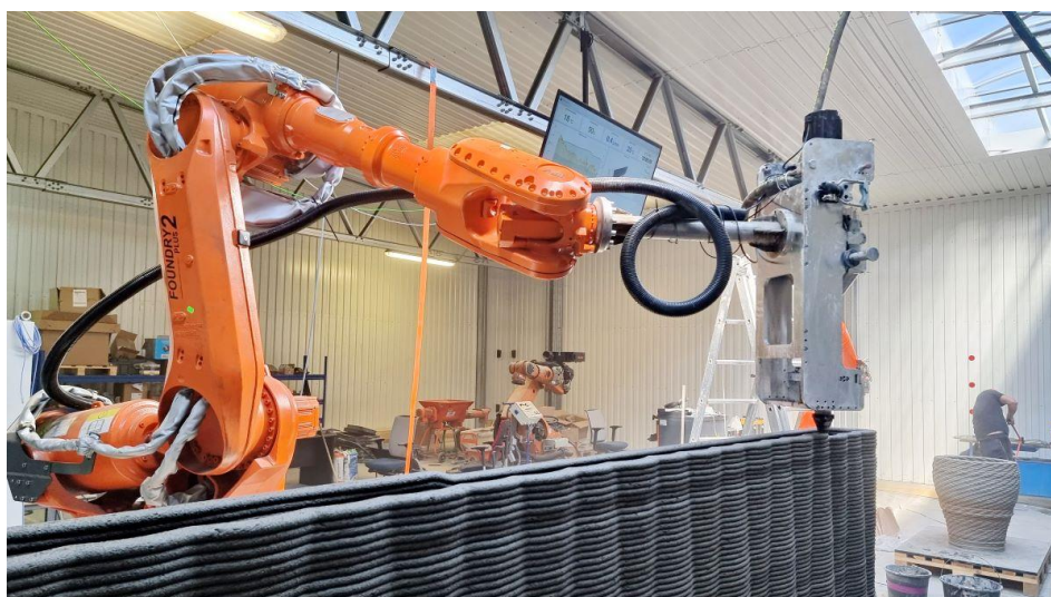
Obrázek 29 3D tiskárna s robotickou rukou [18]
