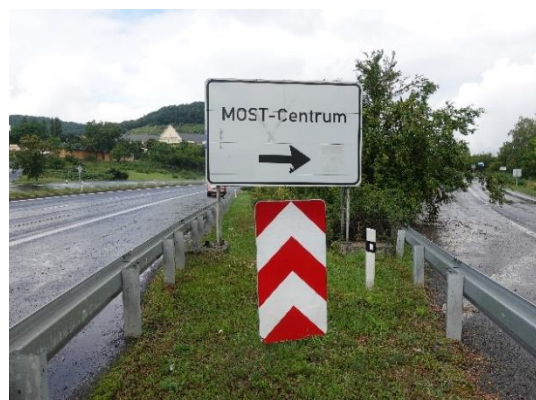
Obrázek 71 – Společné umístění DZ Z 4c a IS 7a v rozštěpu křižovatky. (MÚK I/13 x MK Čsl. Armády)
