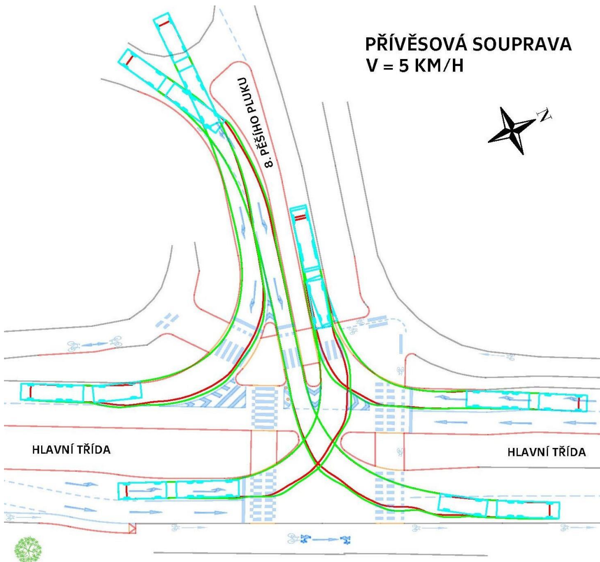
Obr. 9: Křižovatka L1, varianta 1 – Vlečné křivky přívěsových souprav 20
