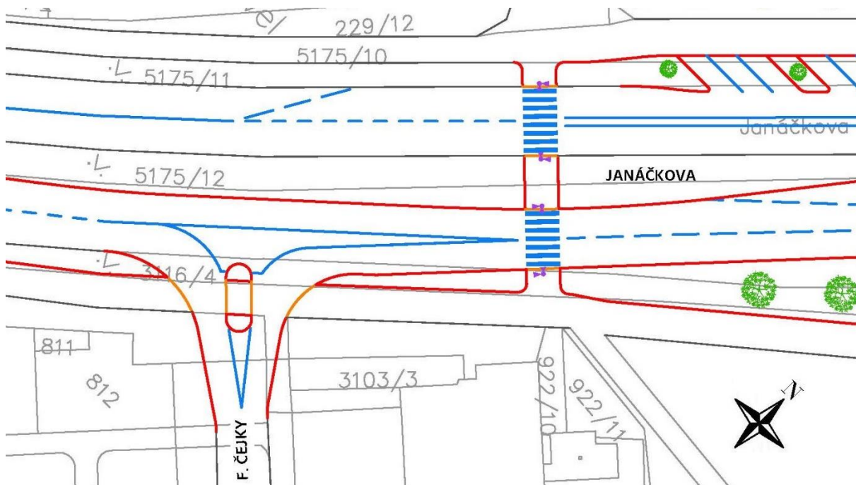
Obr. 34 : Lokalita L5, varianta 2 – Variantní řešení přechodu pro chodce přes ulici Janáčkova s řízením SSZ 45
