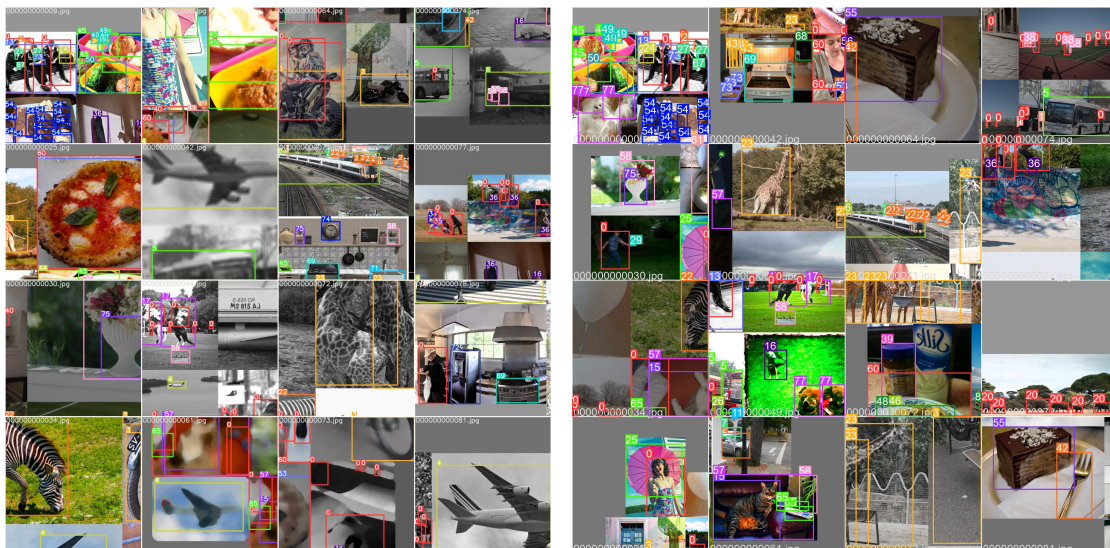
■ Obrázek 3.4 Ukázka augmentace dat pomocí mozaik, zdroj: [16]
