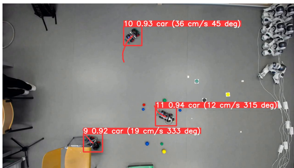
■ Obrázek 5.9 Ukázka detekce a sledování objektů na reálných datech
