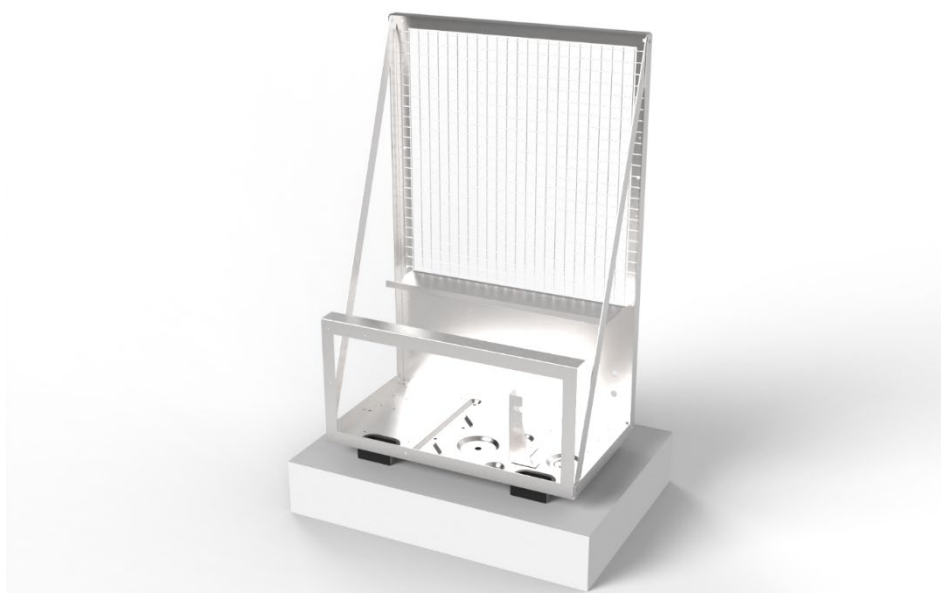
Obr. 77: Autorská tvorba, Nosná konstrukce venkovní jednotky, vizualizace, 2022
