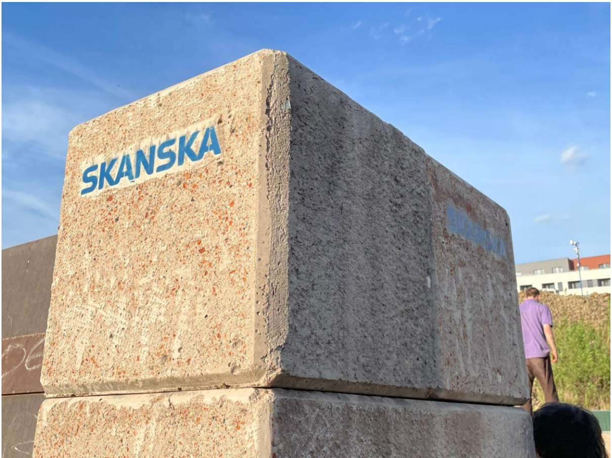
Obr.:24: Povrchově upravený rebetongový blok
