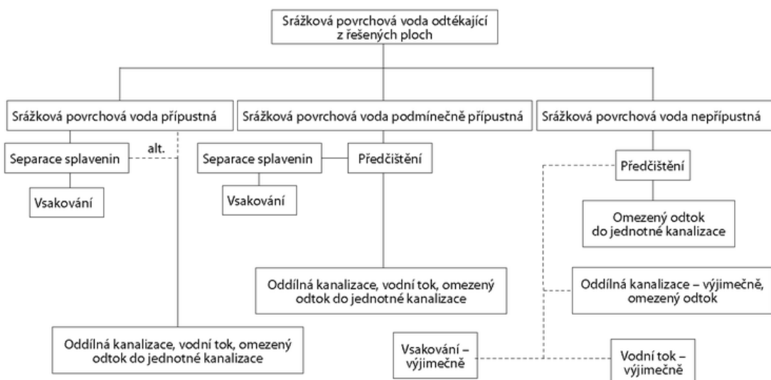
Obr. 2 – Rozhodovacia schéma pre odvádzanie zrážkových vôd [3]
