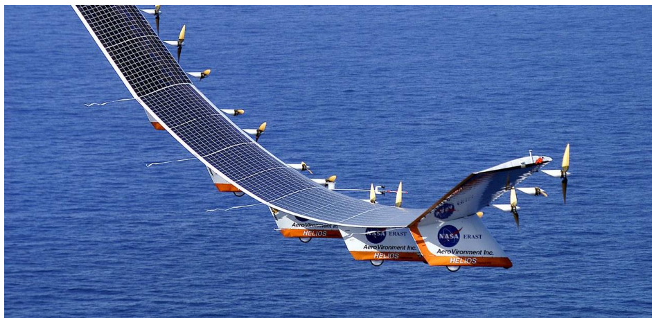
Obr. 48 Ohyb křídel letounu Helios HP1 (14)
