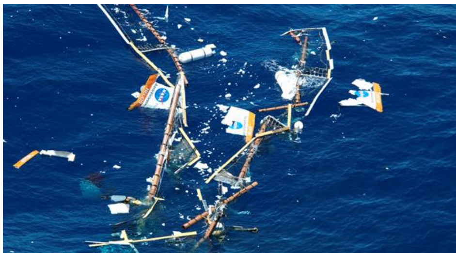
Obr. 49 Fotografie nalezených trosek z havárie letounu Helios HP1 (45)
