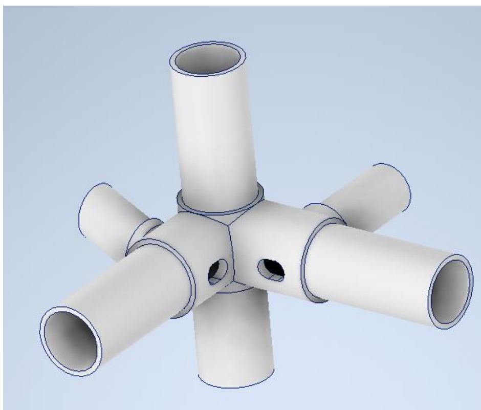
Obr. 5.4 Spojka rámu pohled 2
