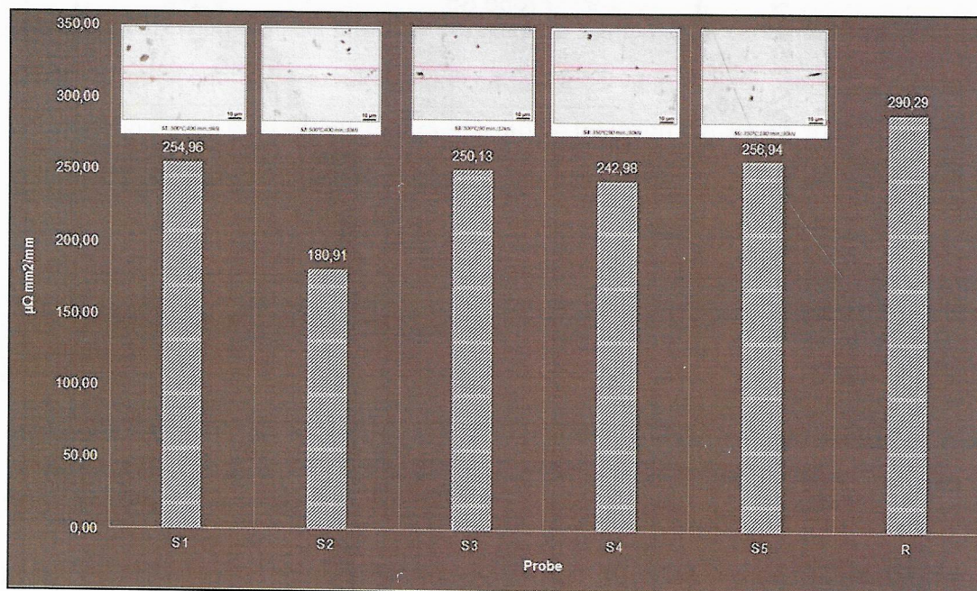
Obrázek 97 Graf elektrické rezistivity při stejnosměrném proudu
