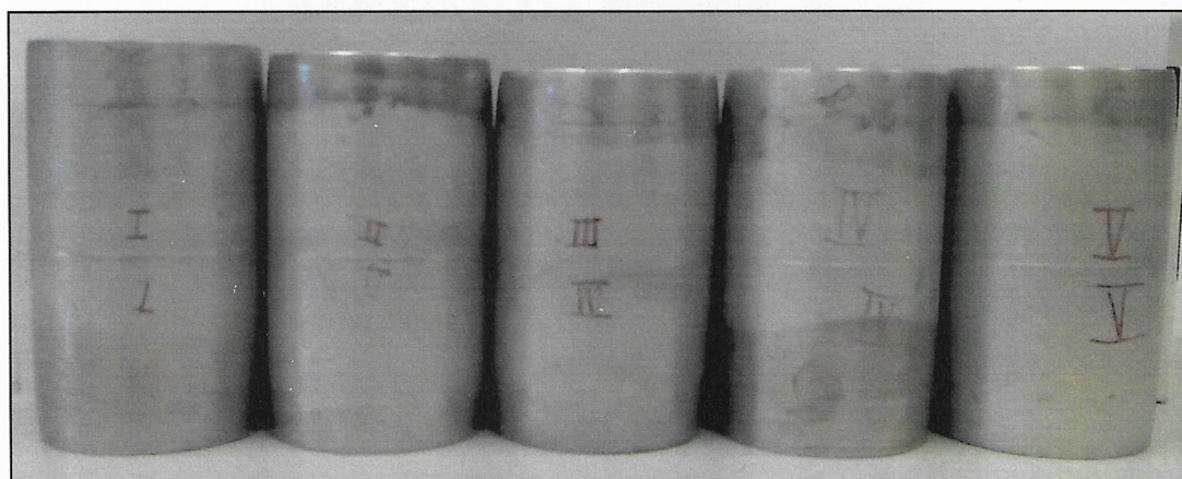
Obrázek 52 Vytvořené vzorky svarových spojů z druhého experimentu
