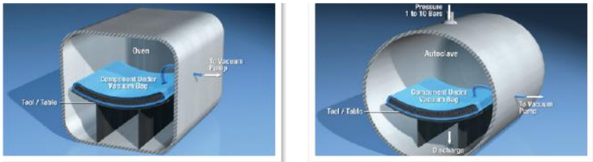
Obr. 24. Vakuová pec (vlevo) a autokláv (vpravo) [22]
