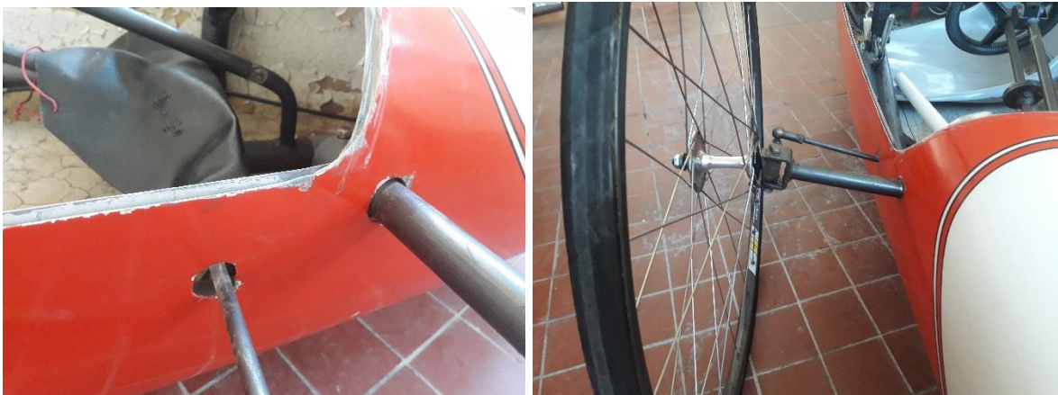
Obr. 32. a Obr. 33. Otvory v karoserii pro přední nápravu a řízení
