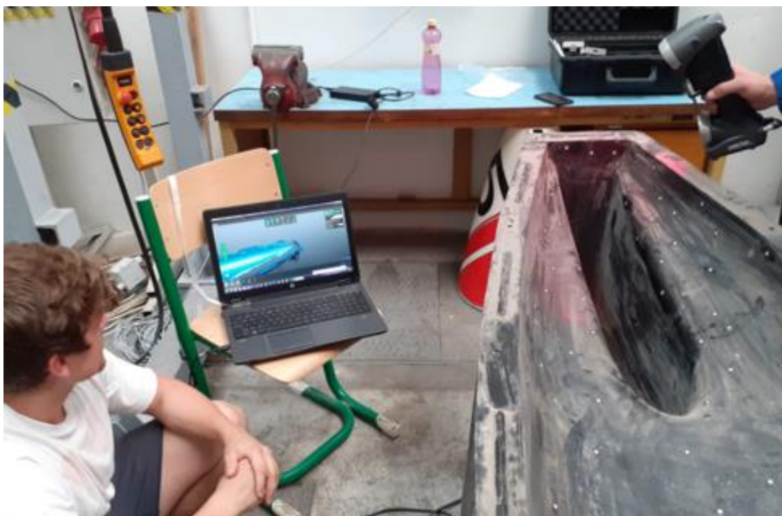
Obr. 36. Skenování spodní části formy původního Ekona
