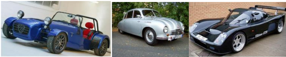
Obr. 5. (zleva) Blatníková, pontonová a proudnicová karoserie [1]
