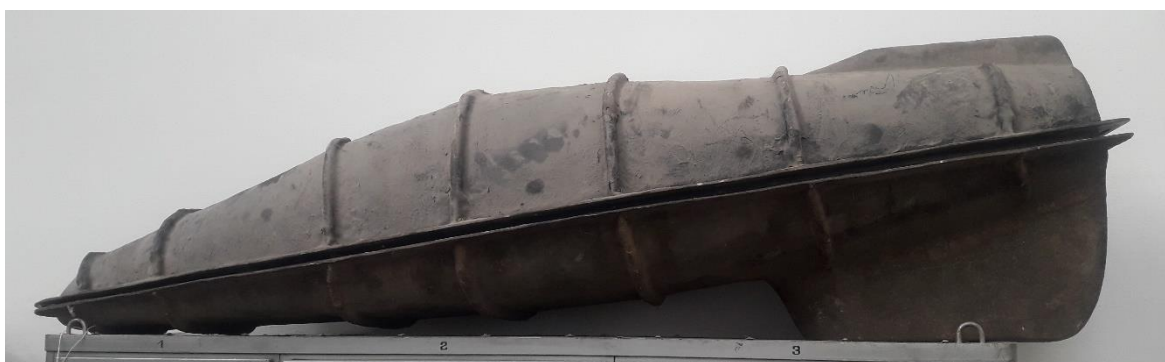
Obr. 19. Dvoudílná forma karoserie původního Ekona (Horní, spodní)
