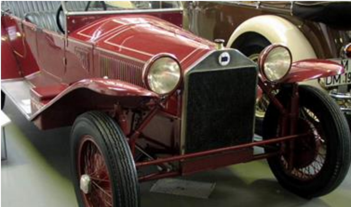
Obr. 7. Ocelová karoserie Lancia Lambda [5]
