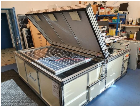
Obrázek 13 - Zařízení na měření elektroluminiscence
