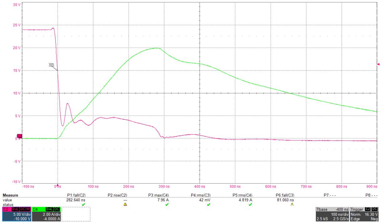
Obr. 11-9 Detail zkratu mezi C/Q - 1M na portu 1
