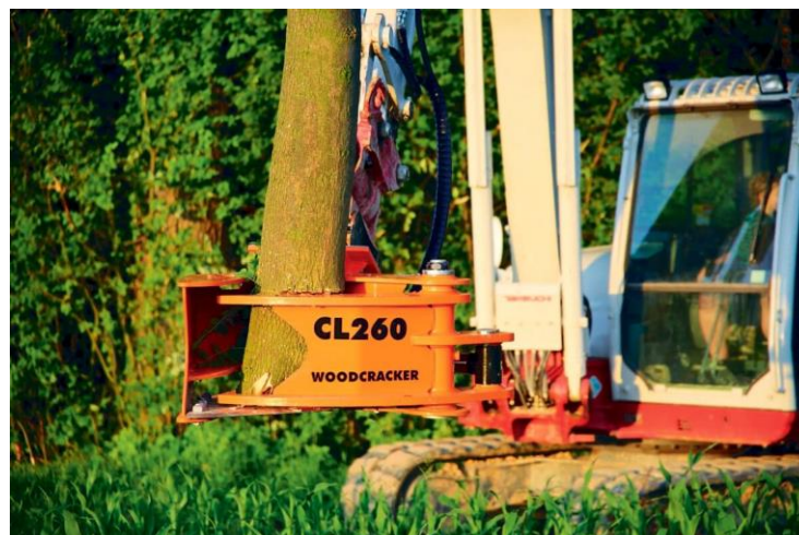
Obr. 9.: Woodcracker CL260 při manipulaci s ustřiženým stromem [2]
