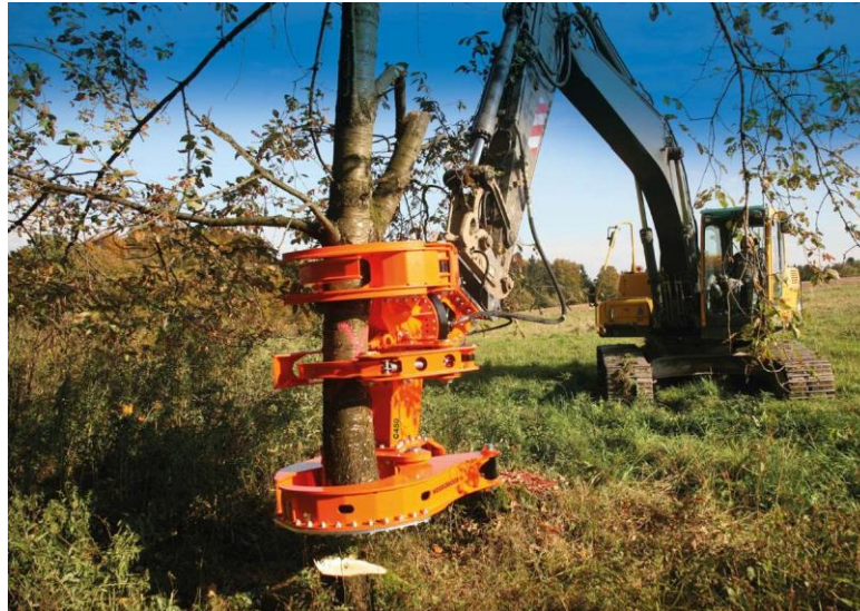
Obr. 8.: Woodcracker C450 při stříhání třešně [2]
