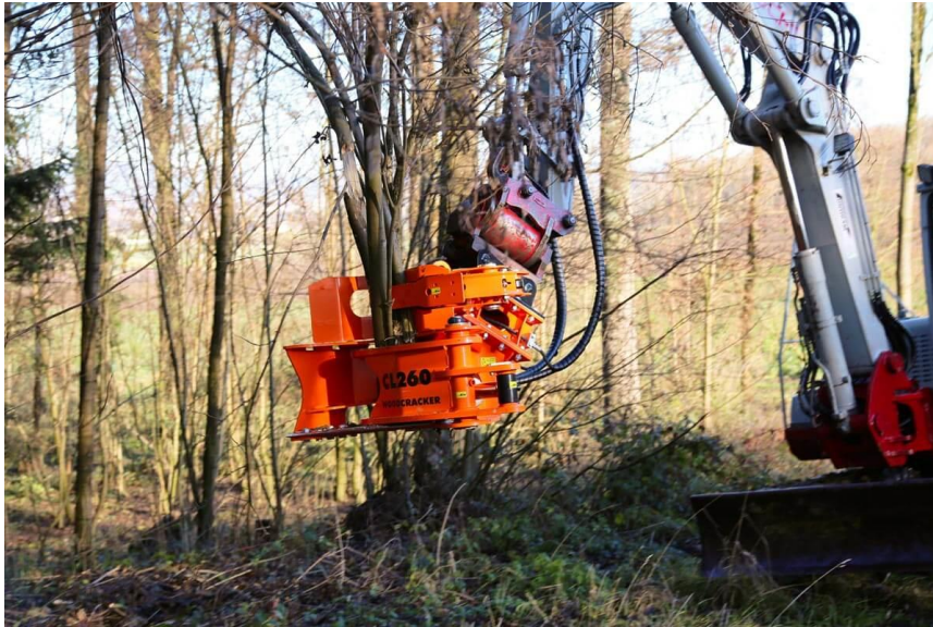
Obr. 5.: Hlavice CL 260 dovybavená sběračem [2]
