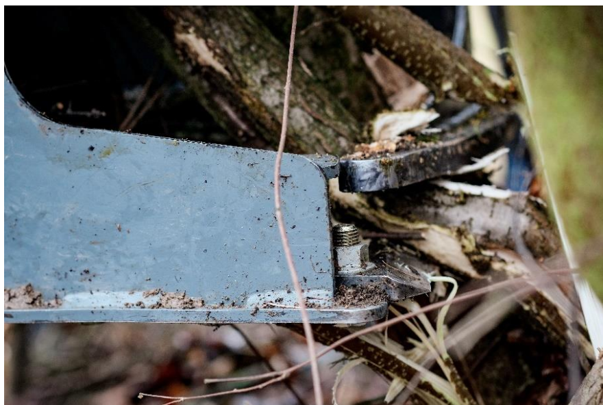
Obr. 53.: Pojíždění čelisti po neustřižené kulatině
