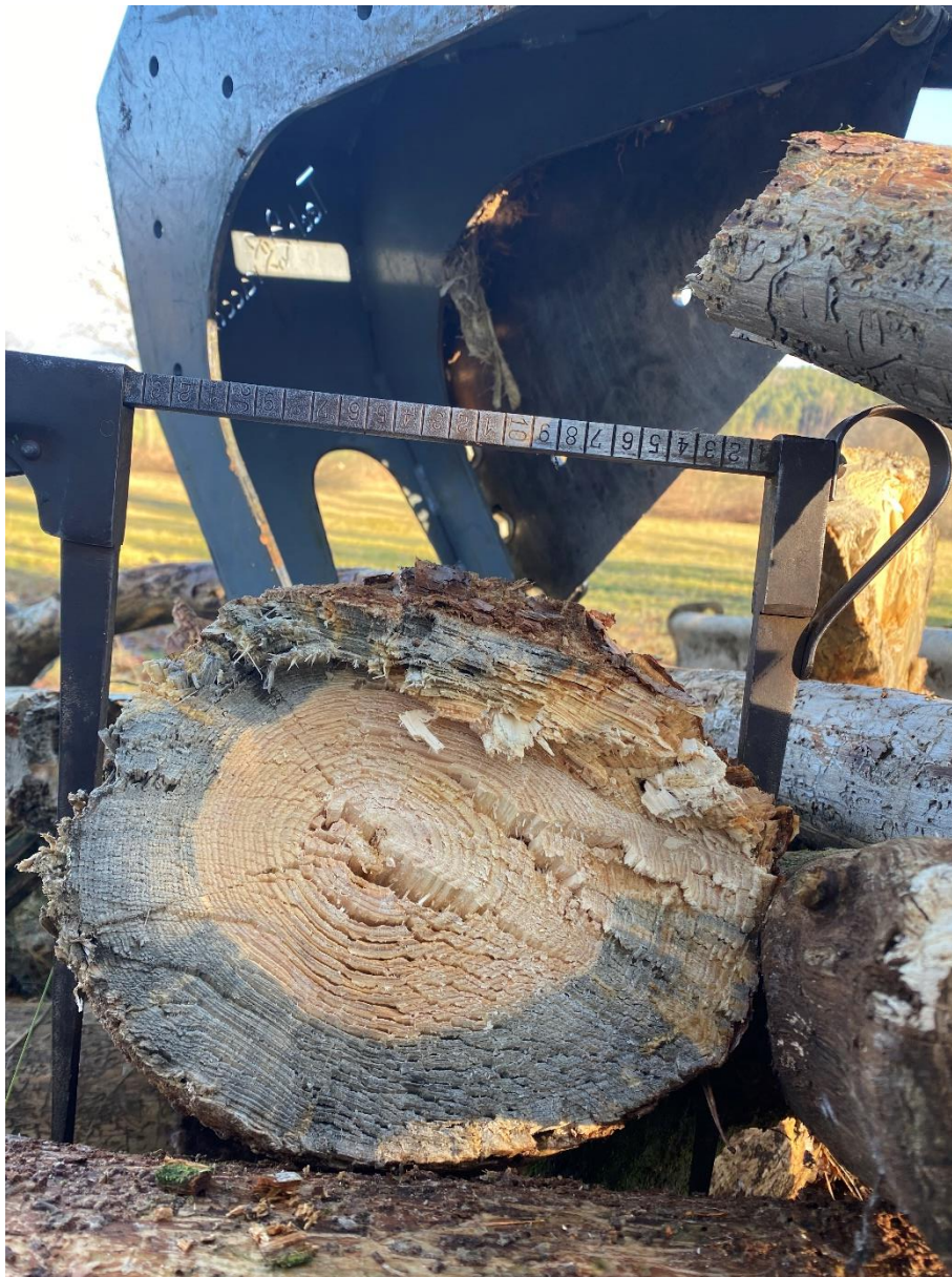
Obr. 51.: Přestřižená borovicová kulatina o průměru 240 mm
