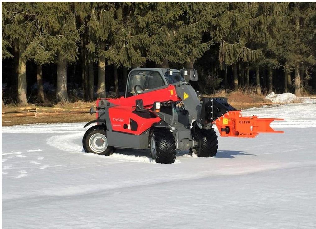
Obr. 1.: Stříhací hlavice CL 190 v kombinaci s teleskopickým manipulátorem [2]
