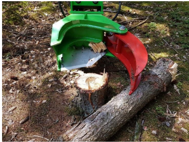
Obr. 2.: Stříhací hlavice EHZ 240 po ustřížení smrku [5]
