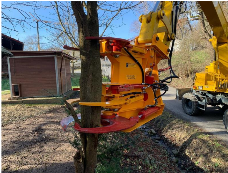
Obr. 4.: Nůžky od společnosti HANS HABBIG s dvojicí protiběžných nožů [4]
