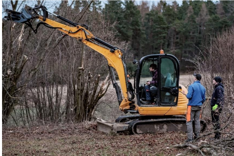
Obr. 52.: Sledování hodnoty tlaku během stříhání lísky
