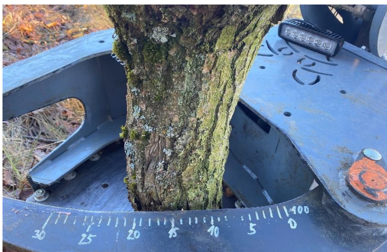
Obr. 47.: Odečítání polohy kulatiny na stupnici čelisti
