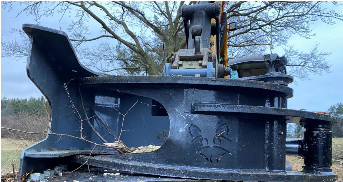
Obr. 54.: Čelist po plastické deformaci
