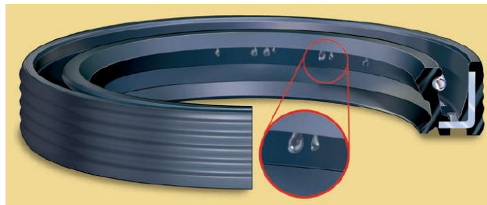
Obr. 41: Tvorba puchýřů na břitu těsnění [8]
