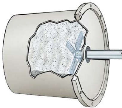
Obr. 39: Zkušební komora pro abrazivní test [6]
