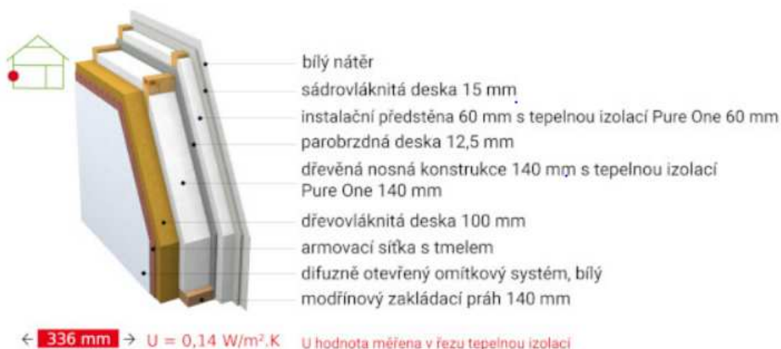
Obrázek 15 – Skladba obvodové stěny ze sendvičové konstrukce
