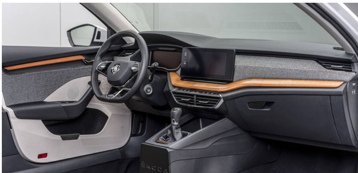
Obrázek 10 Inovativní model Škoda Auto, výplně dveří a sloupky vozidla jsou potaženy látkou na bázi miscanthu a ve výplních dveří a na palubní desce jsou použity hobliny z cukrové řepy - Pert Lichtenberg
