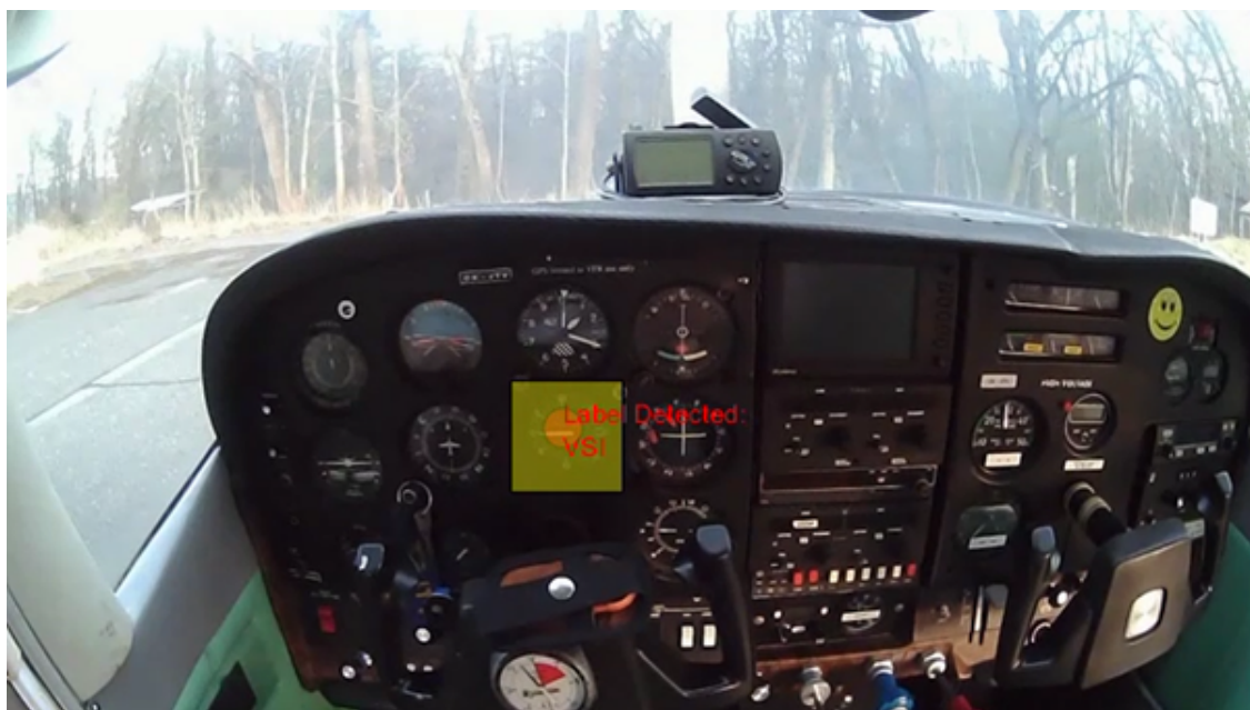
Obrázek 4.5: Výsledná podoba detektoru objektů, obsahující indikaci ROI, kam aktuálně směřuje pozornost.
