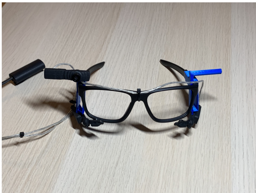
Obrázek 3.3: Finální podoba brýlí pro sledování pohybu očí.
