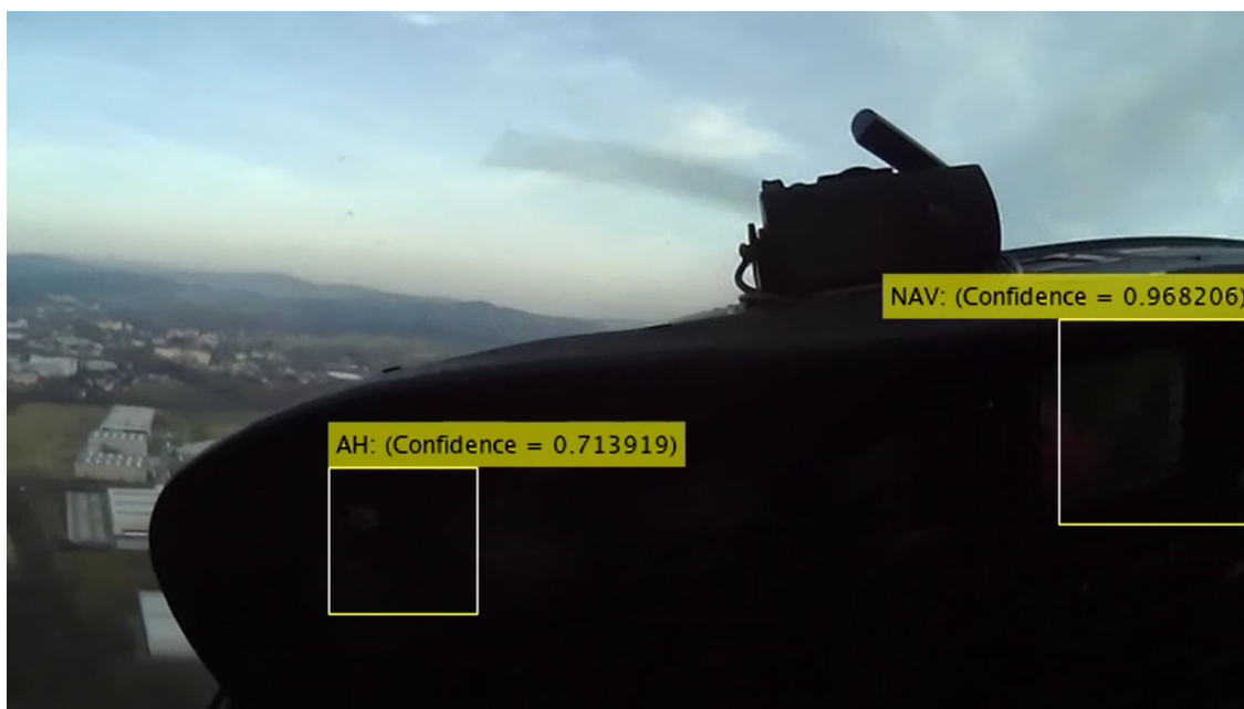
Obrázek 4.6: Příklad špatných světelných podmínek, kdy detekce objektů je neuspokojivá.
