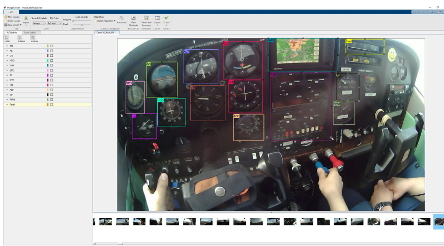
Obrázek 3.6: Tvorba datasetu určeného pro trénování objektového detektoru.
