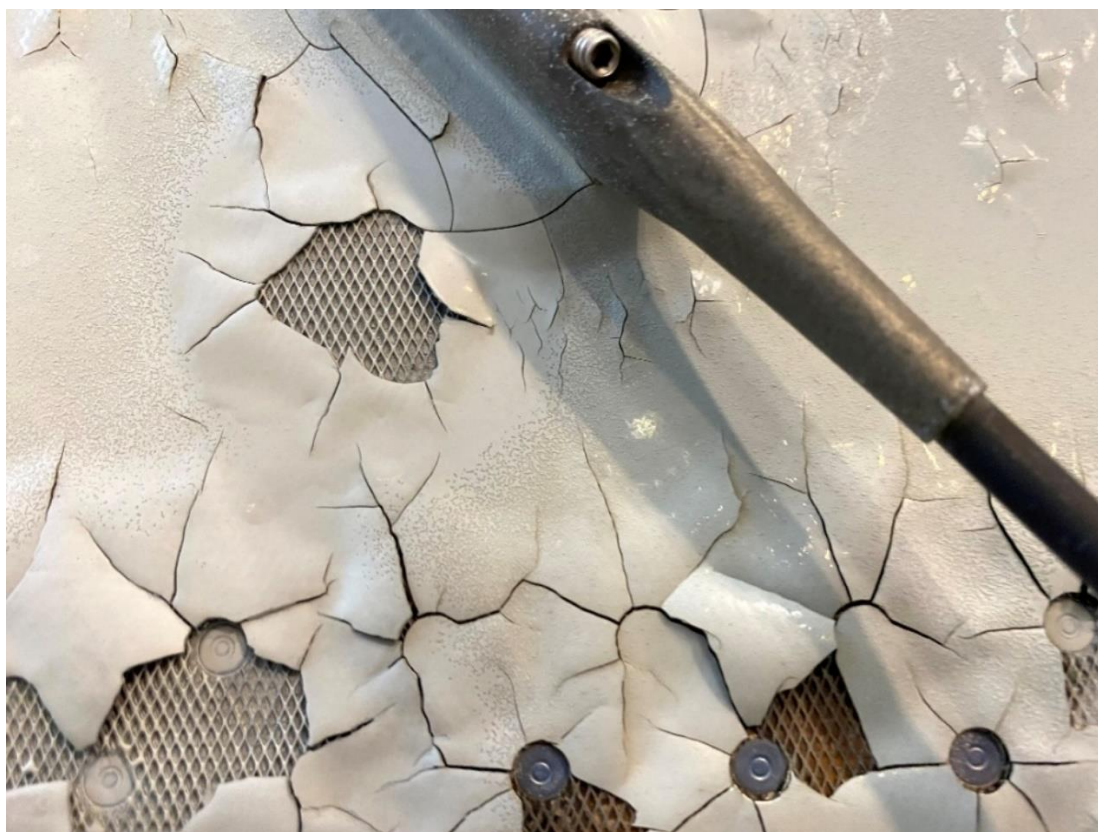
Obrázek 9 - Poškození povrchové úpravy letounu Airbus A350 společnosti Qatar Airways (Zdroj: Reuters.com)
