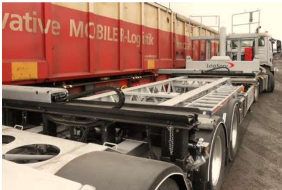
Obrázek 4 - Hydraulický systém Mobiler zajišťující automatickou překládku bez použití externích manipulačních prostředků; [6]
