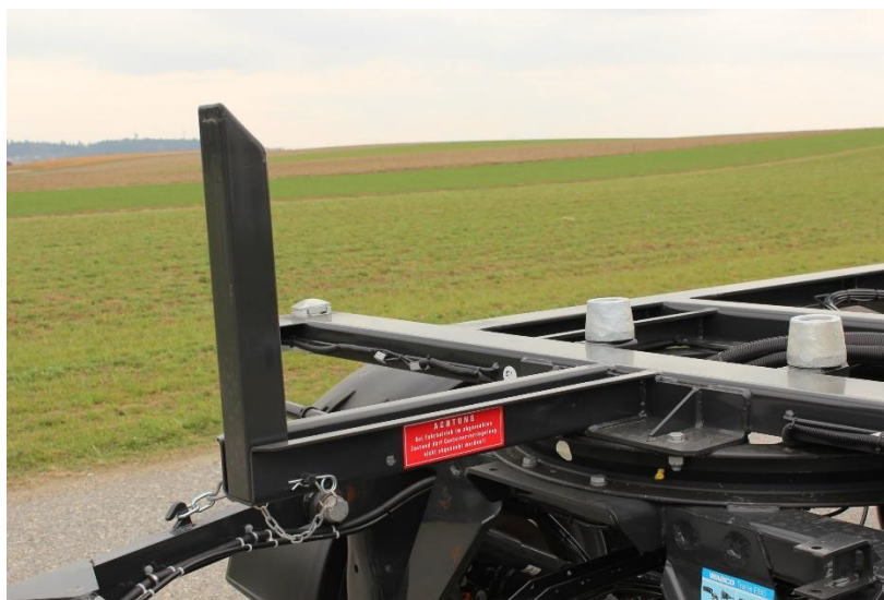
Obrázek 2 - Přívěs pro VN C715 a C745 - dorazová opěra, naváděcí rolny a kontejnerový zámeček; [4]
