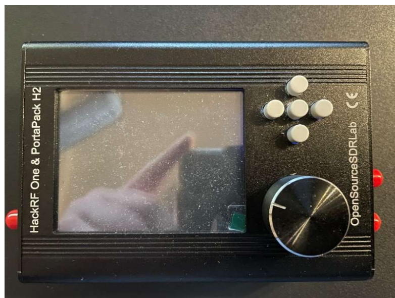
Obrázek 3.2: HackRFone v konfiguraci s PortaPack H2 (zdroj: autor).
