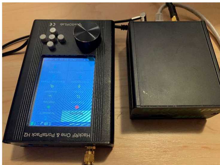
Obrázek 4.12: Propojení TX výstupu SDR s RX vstupem přijímače (zdroj: autor).
