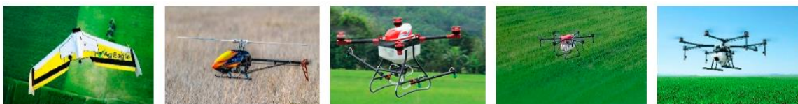
Obrázek 1.7 Druhy UAV dle konstrukce (letoun, vrtulník, kvadroptéra, hexakoptéra, oktokoptéra) [21]
