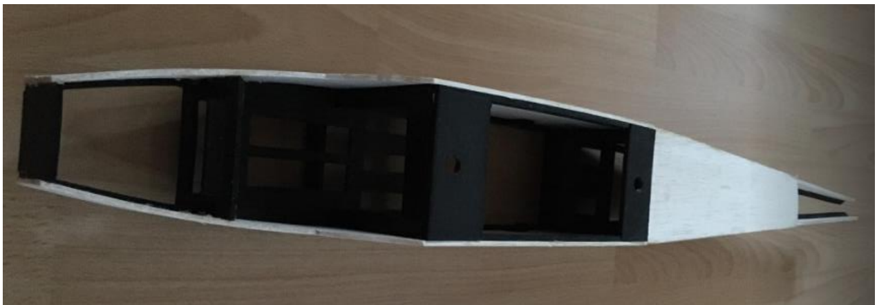
Obrázek 2.26 Hotový trup bez potahu a nosní části
