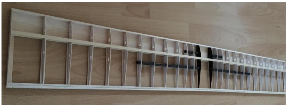
Obrázek 2.20 Téměř hotové křídlo bez horního tuhého potahu
