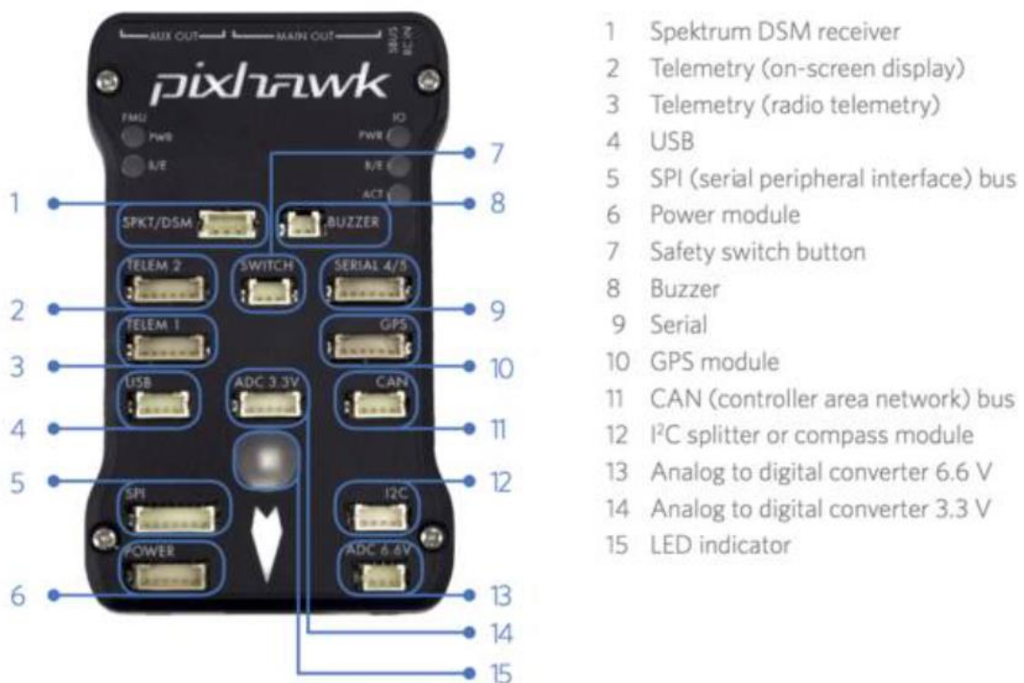
Obrázek 2.1 Možnosti připojení externích modulů k PixHawk 2.4.8. [38]
