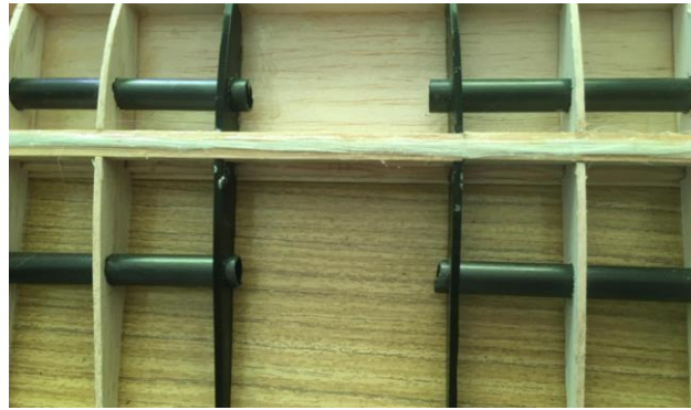
Obrázek 2.21 Zpevnění křídla pomocí skelných vláken
