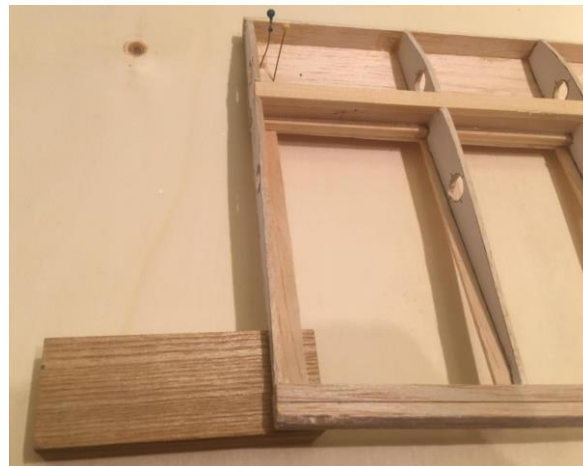
Obrázek 2.22 Tvarování zkroucení křídla
