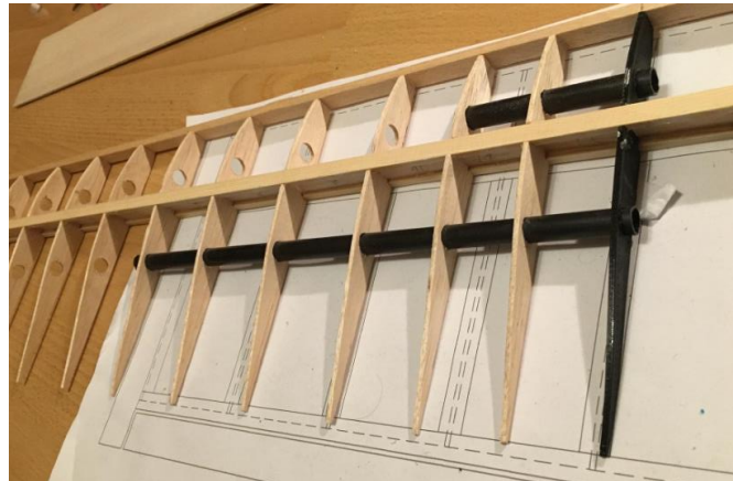
Obrázek 2.19 Žebra spojené hlavním a předním nosníkem
