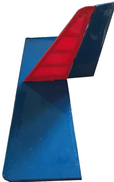
Obrázek 2.27 Téměř hotové ocasní plochy bez výškového kormidla
