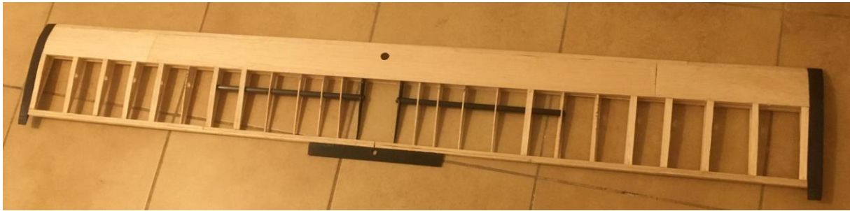
Obrázek 2.23 Hotové křídlo bez potahu
