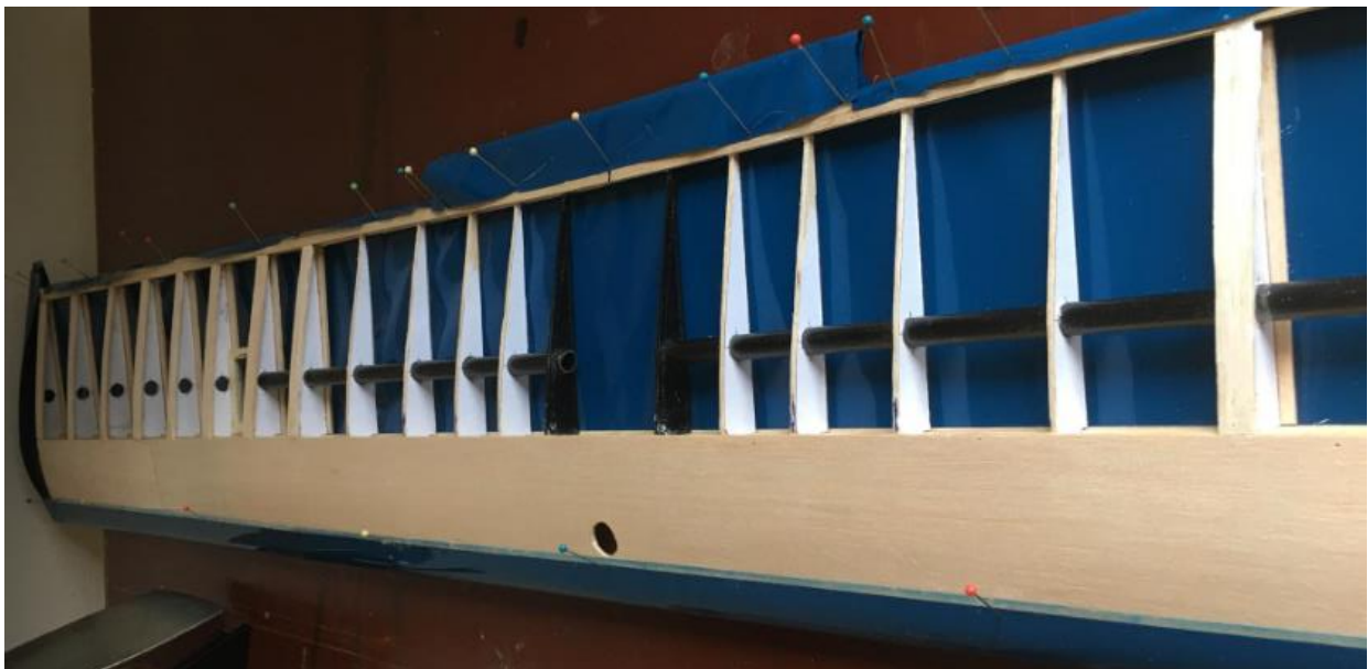
Obrázek 2.24 Potahování křídla nažehlovací fólií
