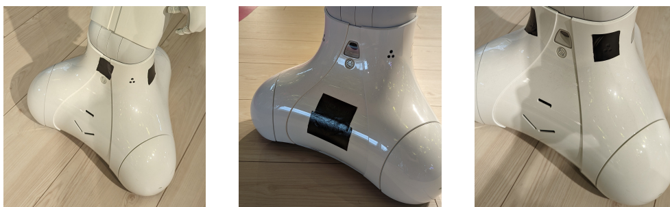
Obrázek 6.6: Zakryté laserové senzory, „shovel“ senzor a infračervený senzor
