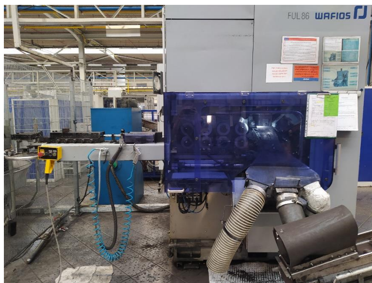
Obrázek 24 Stroj FULL 86 (z levé strany: návin, podavač a hlavní část stroje), (Vlastní fotografie)
