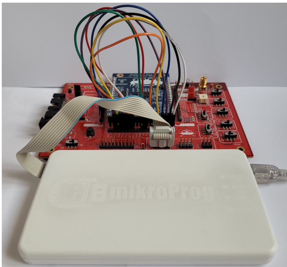
Obrázek 2.7: Reálné zapojení HW programátoru mikroProg k UFO desce obsahující CEC1702 NewAE target
