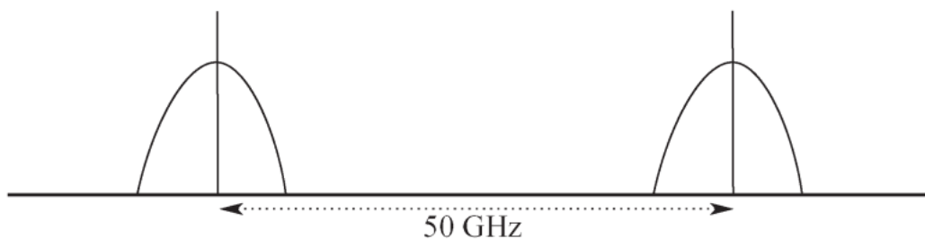
■ Obrázek 1.1 Fixní mřížka, vzdálenost uzlů od sebe bude nastavena na 50 GHz pro libovolné přenosové rychlosti. I tam, kde by nemuselo zůstat tolik frekvence nevyužito [1]
