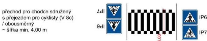
Obrázek 13 – Ukázka sdruženého přechodu pro chodce a přejezdu pro cyklisty - V 8c (zdroj: TP 179)
