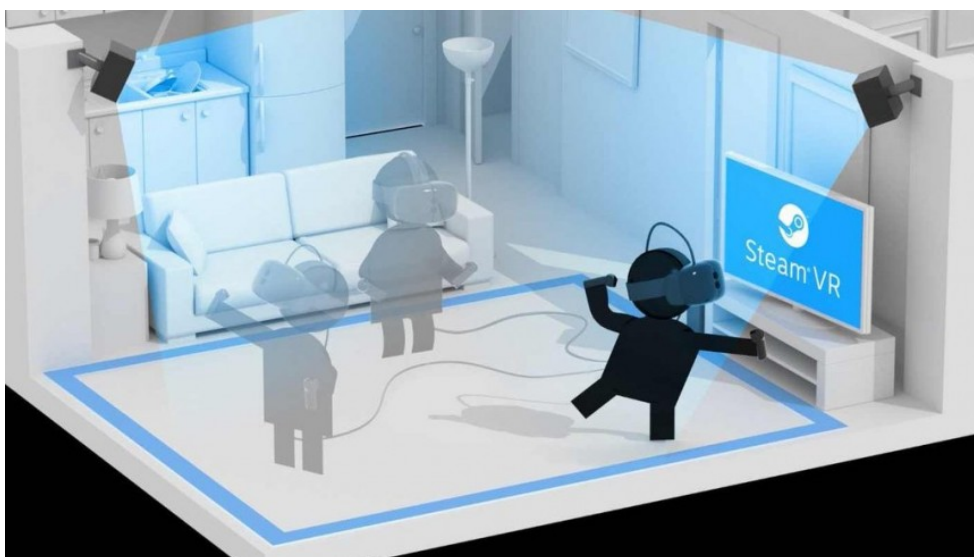
Obrázek 2.10: Nákres rozmístění dvou kamer od HTC Vive headsetu podporující outside-in tracking [17].
