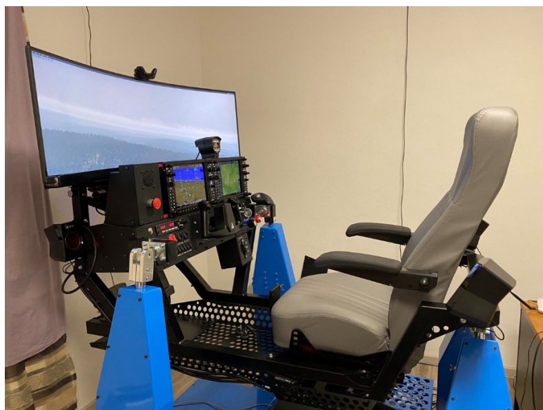
Obrázek 1: Letecký simulátor na pohyblivé platformě
