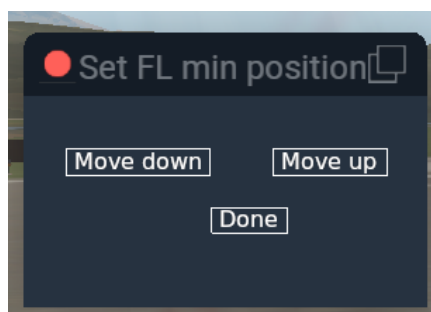
Obrázek 15: Rozhraní pro nastavení dolní polohy servomotoru
